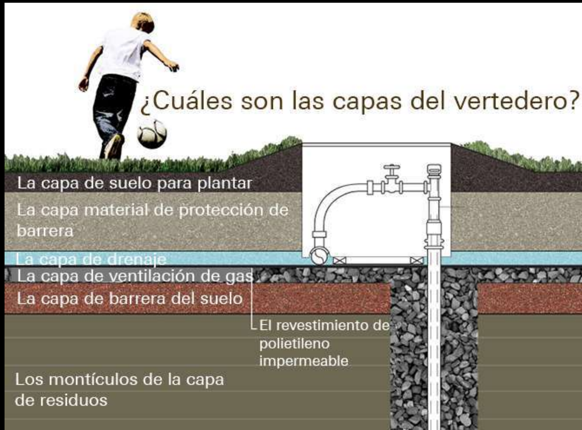
GRÁFICA DE LAS DIFERENTES CAPAS DE UN VERTEDERO POR: FRESHKILLS PARK
