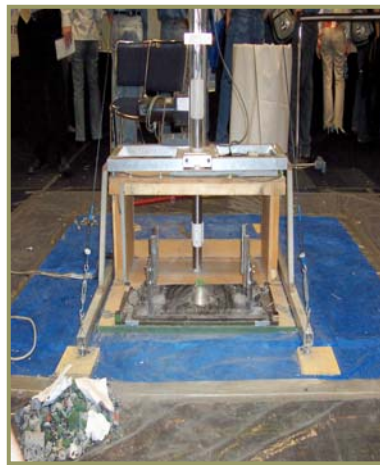
Base donde se colocan las muestras y aparato usado para levantar la pesa
