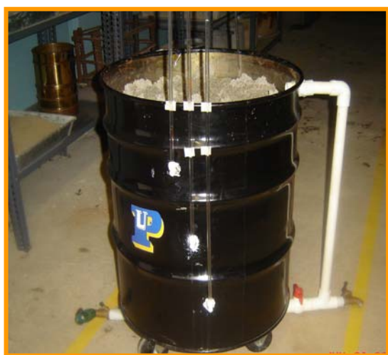
Figura 3. Piezómetros ubicados a diferentes elevaciones
