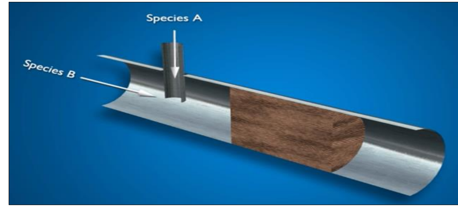
Figura 2 Modelo de Reactor Poroso con Aguja de Inyección incluyendo catalítico [4]
